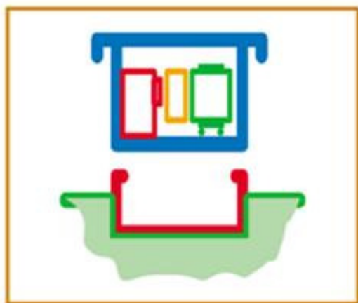
شکل (۱۱): پست پیش‌ساخته کمپکت با احداث فونداسیون در محل
